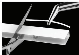
Couper la longueur de renfort au travers des protection de silicone et papier avec une paire de ciseaux. La conserver en la protégeant de la lumière.
